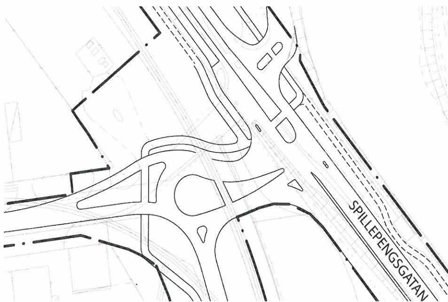
Utformning med s.k. droppe vid Spillepengsgatan/ Bjurögatan
